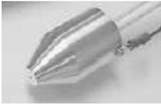
Un analyseur à fluorescence X portable contient un tube à rayons X miniaturisé, dont le diamètre est d'environ 20 mm, qui fonctionne à une tension entre 15 et 50 keV, avec un courant entre 2 et 200 micro-ampères. En dépit de sa petite taille, le tube à rayons X peut produire des rayonnements intenses (environ 2 000 R/h) à la fenêtre de sortie.
