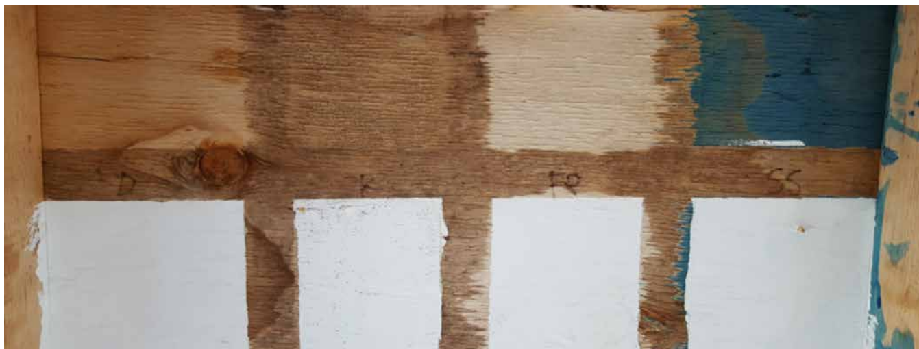
Figure 4 Panneau échantillon montrant différents traitements de revêtement appliqués sur du bois propre pour comparer leur efficacité à limiter la croissance microbienne.
