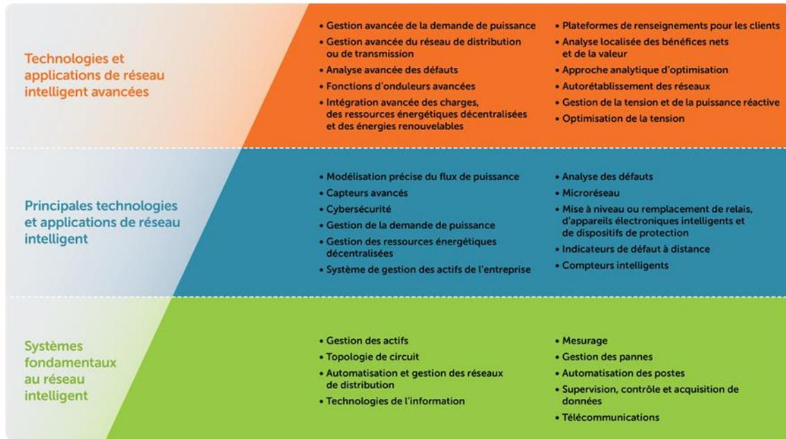
**Figure 4 : Niveaux de technologies et d'applications de réseau intelligent**
