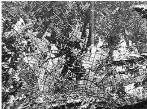
Les capteurs radars sont également utiles pour le tracé des applications rurales et urbaines grâce à leur sensibilité aux formes géométriques qui permet de détecter les éléments anthropogéniques comme les édifices. L'arrangement géométrique optimal entre le capteur et la région urbaine est une orientation linéaire, parallèle au mouvement du capteur, et perpendiculaire à l'énergie (L) incidente reçue.
