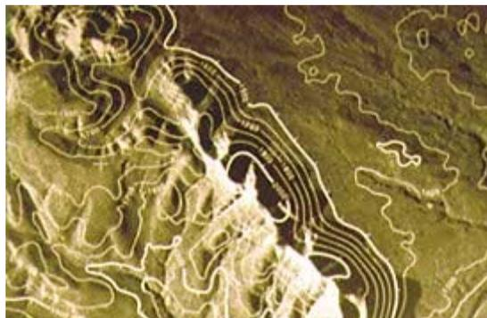
Les lignes de contours peuvent être générées à partir de MNA pour la production de cartes topographiques, de modèles de pente et d'orientation. Ceux-ci sont utilisés pour l'intégration avec des séries de données de classification thématique (utilisation du sol), pour la correction géométrique d'autres images ou pour la création de vues en perspective.
