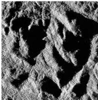
L'effet d'ombrage radar sur le côté droit d'une colline illuminée par la gauche
