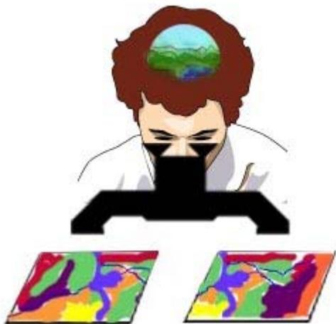
Lorsqu'on observe un couple d'images en stéréoscopie, on perçoit un modèle 3D virtuel de l'objet ou du terrain imagé. Par ce modèle 3D virtuel de terrain (MVT), il est possible d'extraire de l'information cartographique sans utiliser un MNT!
