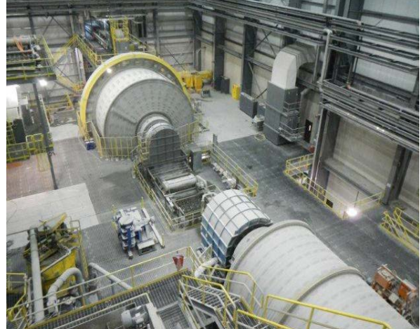
Photo : New Gold Inc. Les broyeurs du circuit brisant des matières solides en plus petits morceaux.
