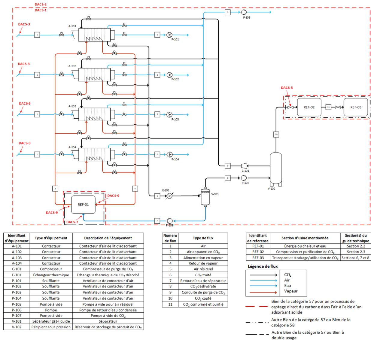
Figure 4.1-2 : Exemple de processus de captage atmosphérique direct du carbone à l'aide d'un adsorbant solide.
