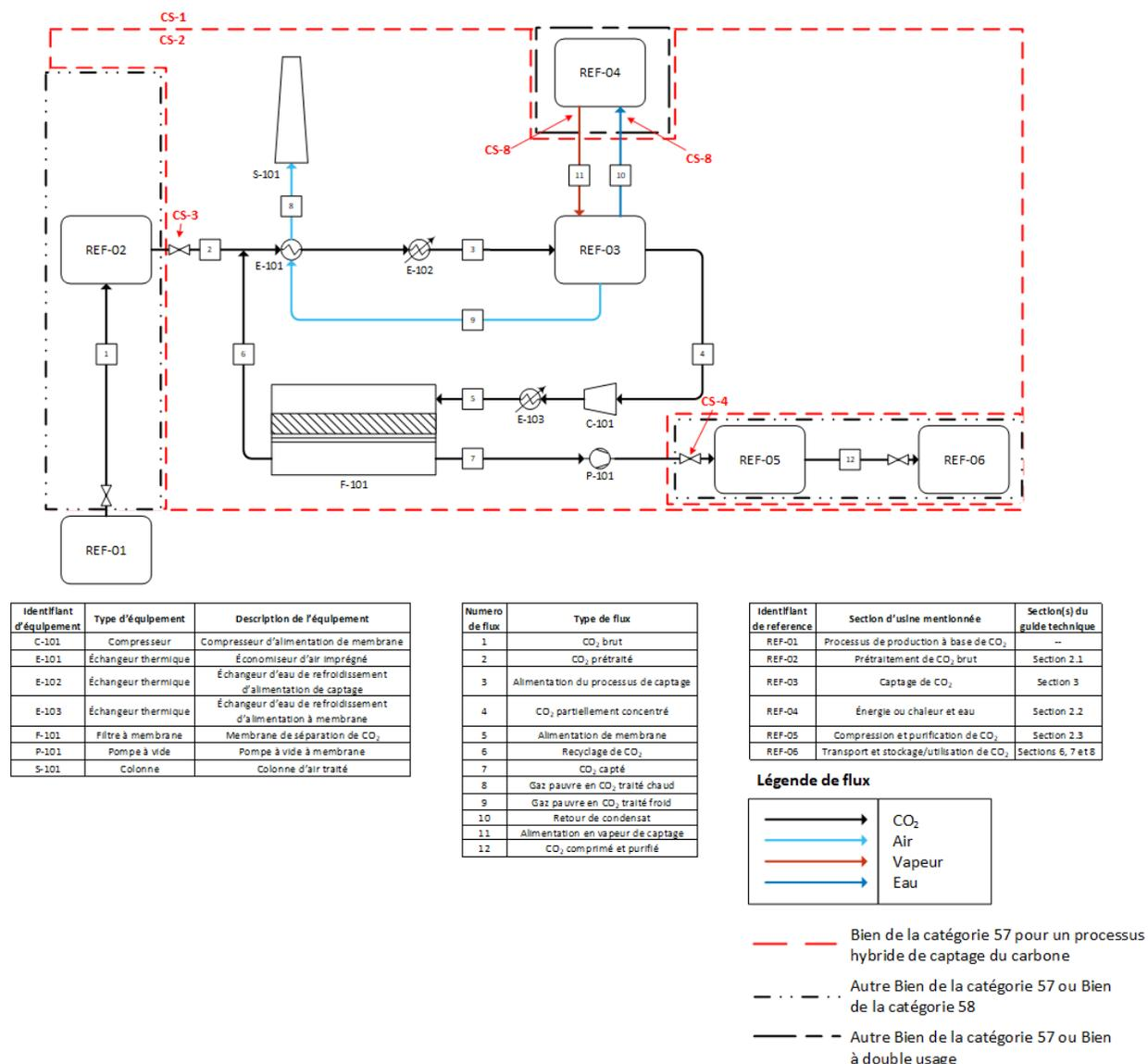
**Figure 3.3-2 :** Exemple de processus de captage du carbone par membrane fondé sur un processus hybride alliant la technologie à membrane et une autre technologie de captage du carbone.
