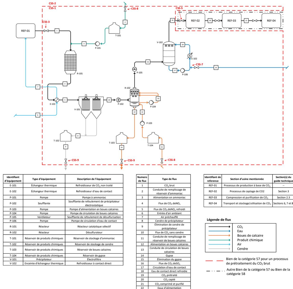
**Figure 2.1-1 : Exemple de processus de prétraitement du CO<sub>2</sub> brut.**
