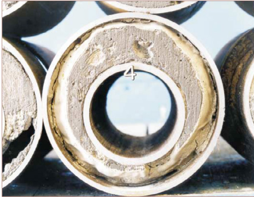
Figure 4.2 Déplacement incomplet de la boue de forage causant des passages pour le ciment et le fluide de forage. Avec le temps, le gel dans le fluide de forage se résorbe et laisse fuir le gaz dans l'espace annulaire (Watson et al., 2002).
