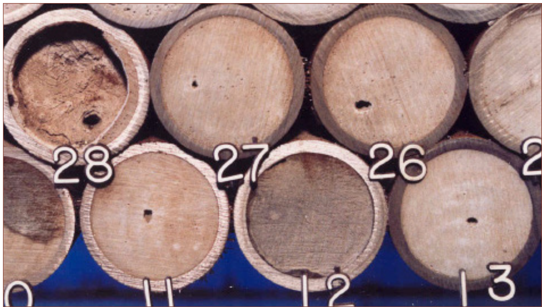
Figure 4.3 Passages et poches de gaz dans le ciment durci à cause de la migration de gaz (Watson et al., 2002).
