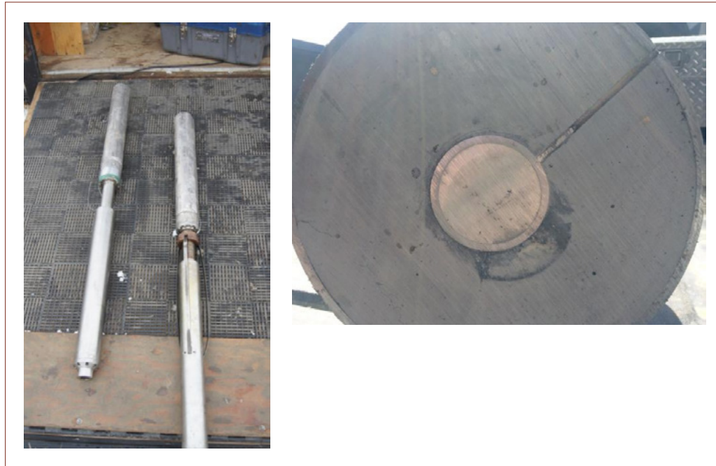
Figure 6.1 Les outils Seal Well de mise en place d'alliages de scellement de puits et d'un alliage de bismuth-étain coulé sur l'extérieur d'une cartouche chauffante. Cette technologie peut servir à la fois pour sceller les puits avant leur abandon ou restaurer des puits qui fuient. Dans l'un et l'autre cas, on abaisse l'outil dans un bouchon provisoire mécanique et on allume la cartouche chauffante. La seconde image montre un système analogue pour puits de forage avec perforation remplie d'alliage (Spencer et Lightbown, 2015).
